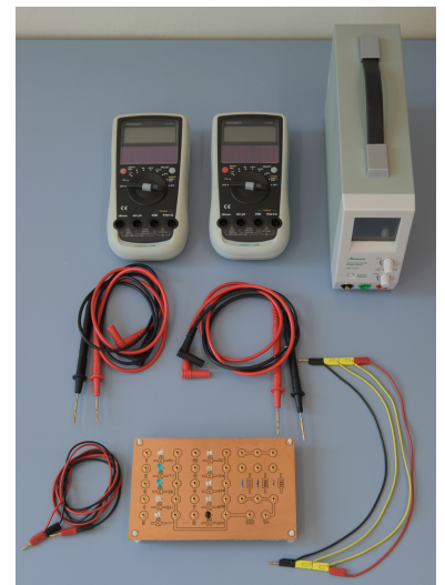
Abbildung 63. Mit einfachen Mitteln ist durch bekannte LED-Wellenlängen die Bestimmung des Wirkungsquantums möglich.
