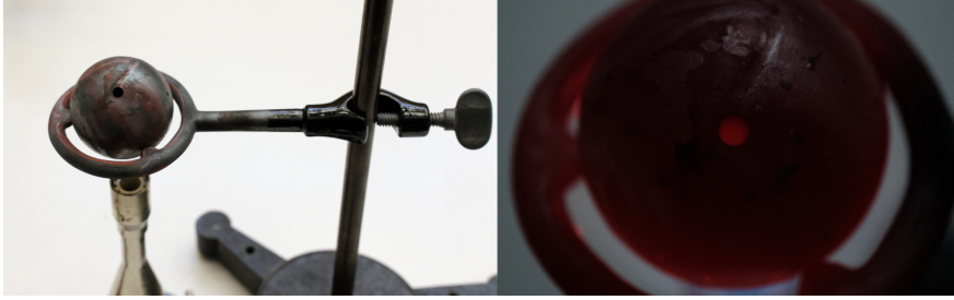
Abbildung 61. (links) Eisenkugel mit Bohrung bei Zimmertemperatur: Die Bohrung absorbiert das Licht und erscheint dunkel im Vergleich zur Oberfläche. (rechts) Die Kugel wurde einige Minuten lang erhitzt bis zur Rotglut. Die Bohrung emittiert nun mehr Licht als die Oberfläche.
