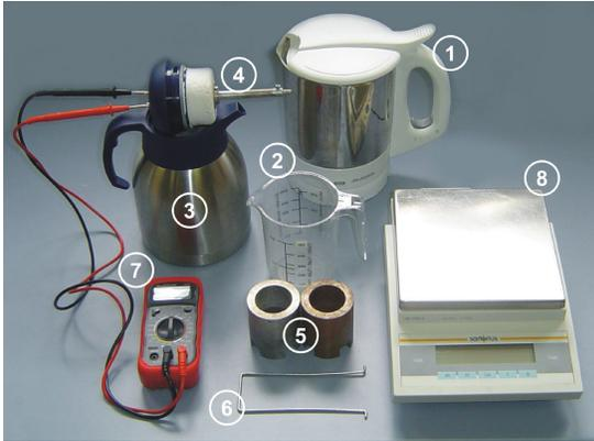
Abb. 4: Gesamtansicht der Versuchsanordnung. 1: Wasserkocher, 2: Messbecher, 3: Kalorimeter, 4: Kalorimeterdeckel mit Temperatursensor, 5: Probekörper aus Al und Cu, 6: Drahtbügel zum Versenken eines Probekörpers, 7: Ohmmeter (Multi-Meter), 8: elektronische Waage.
