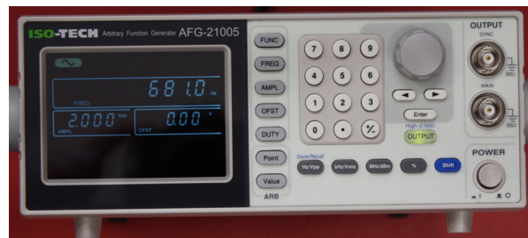
Abb. 5: Funktionsgenerator für verschiedene Signalformen (u.a. Sinus, Rechteck, Dreieck).
