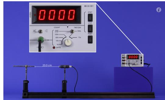
Abb. 6: Versuchsaufbau des interaktiven Bildschirmexperimentes zur Untersuchung des Abstandsgesetzes.
