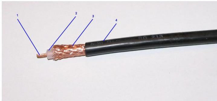
Abb. 3.11: Koaxialkabel mit Leitungswellenwiderstand  $50\ \Omega$ . 1: Innenleiter (Seele), 2: Dielektrikum (Isolation zwischen Innen- und Außenleiter), 3: Außenleiter (Abschirmung, hier einfach ausgeführt, zuweilen auch zweifach). 4: Isolier- und Schutzmantel
