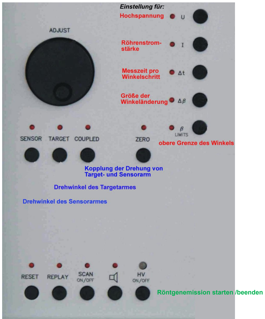
Abb. 11: Erläuterungen zum Bedienfeld des Gerätes.
